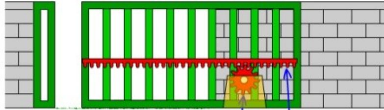
Puerta corredera accionada por un mecanismo
